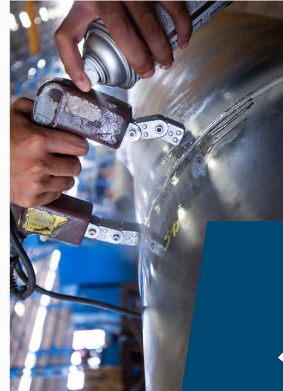
Ensaio de Partículas Magnéticas para detecção de trincas superficiais e subsuperficiais
