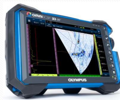
Ultrassom com tecnologia convencional e phased array, para detecção e dimensionamento de trincas
