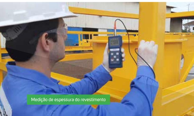
Medição de espessura do revestimento
